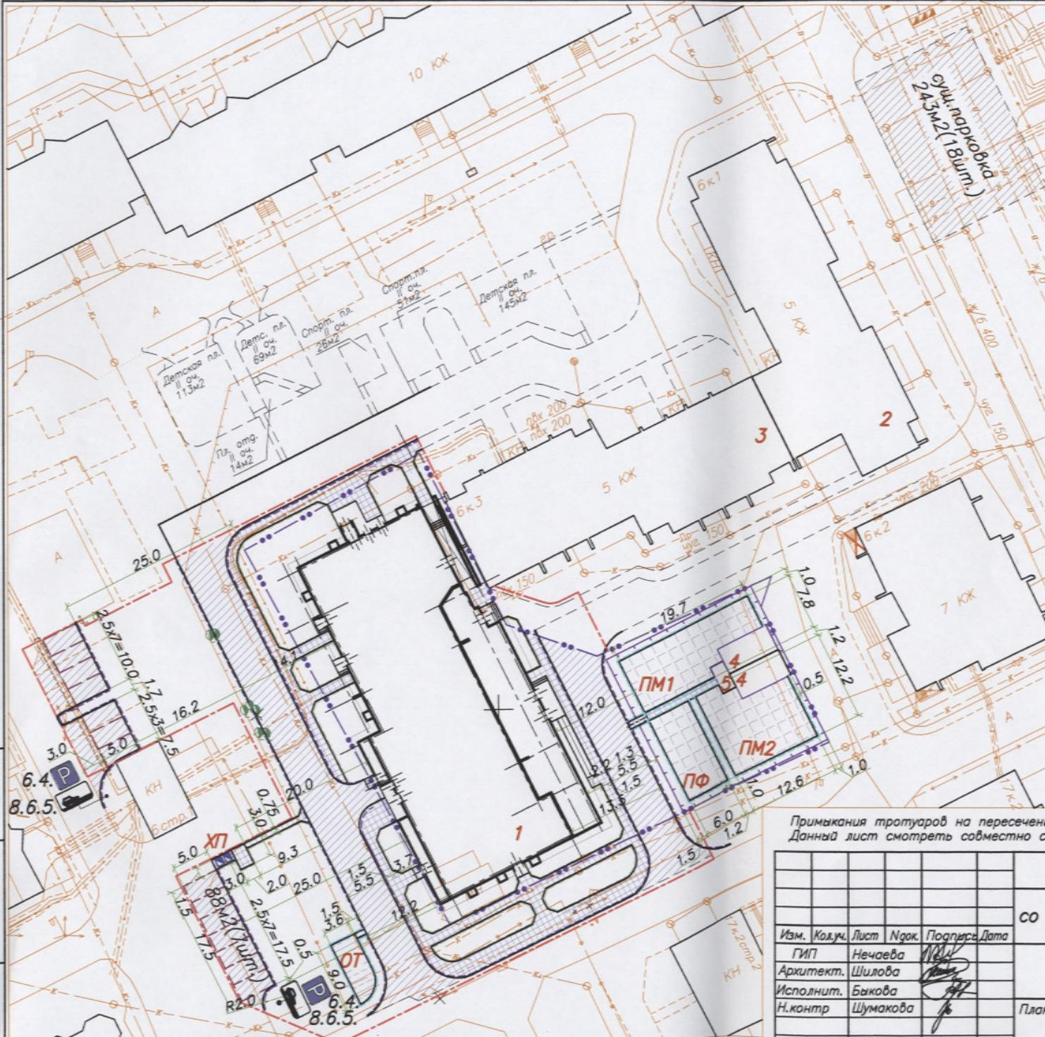
*Примыкания тротуаров на пересечениях выполняются фаской 1.0Х1.0м.
